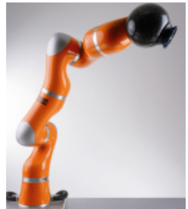
Der KUKA-Leichtbauroboter ist durch Einsatz von CFK-Strukturen nur 14kg leicht und dadurch energieeffizient. (Bild: KUKA Roboter GmbH)
